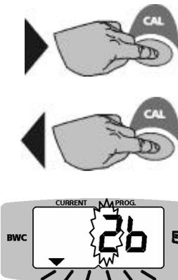
Einschalten der Spannungsversorgung während diese Taste gedrückt ist.
