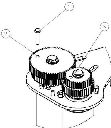
Wenn die Schraube (1) in der Position 2 montiert ist, dann bewirkt das obere Zahnradpaar eine Vorstreckung von 70 %. Montiert man die Schraube in der Position 3 so bewirkt das untere Zahnradpaar eine Vorstreckung von 33% (für speziellen Folie, die bereits vorgestreckt ist) oder optional 55 % für die Benutzung von normaler Folie in heißeren Regionen oder bei Rechteckballen.
